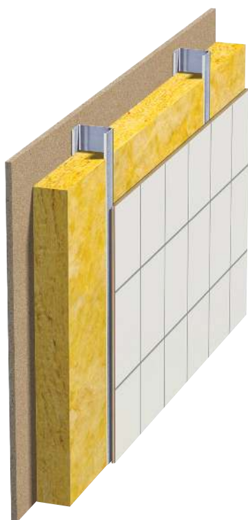
Fig. 5 Innervägg Genomgående stålprofiler med enkel skiva.
