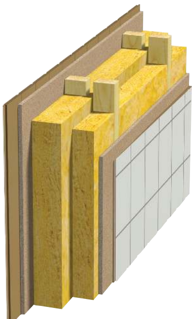
Fig. 4 Innervägg Dubbla träreglar, dubbla skivor.
