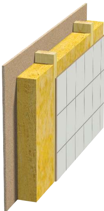
Fig. 1 Innervägg Genomgående träreglar. Enkel skiva.
