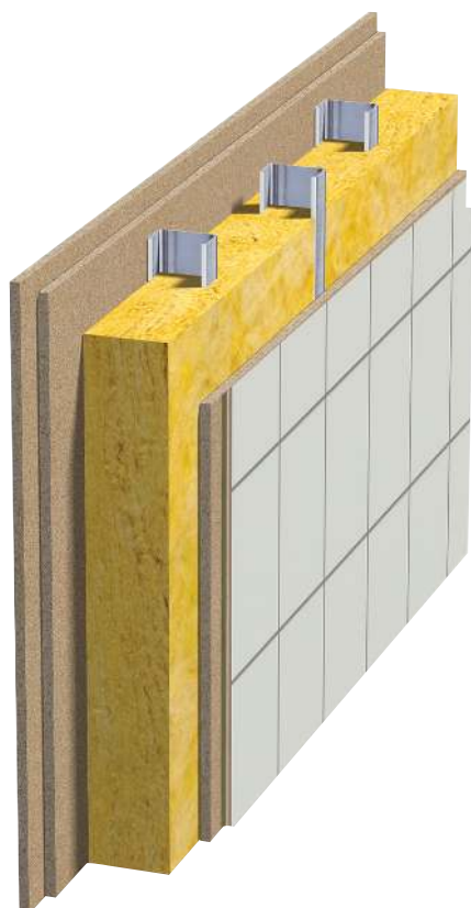
Fig. 6 Innervägg Förskjutna stålprofiler med dubbla skivor.
