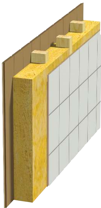
Fig. 2 Innervägg Förskjutna träreglar på träsyll. Enkel skiva.
