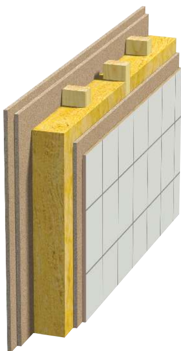
Fig. 3 Innervägg Förskjutna träreglar träsyll. Dubbla skivor.
